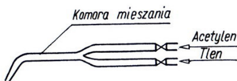
Rys. 24. Schemat palnika wysokiego ciśnienia
